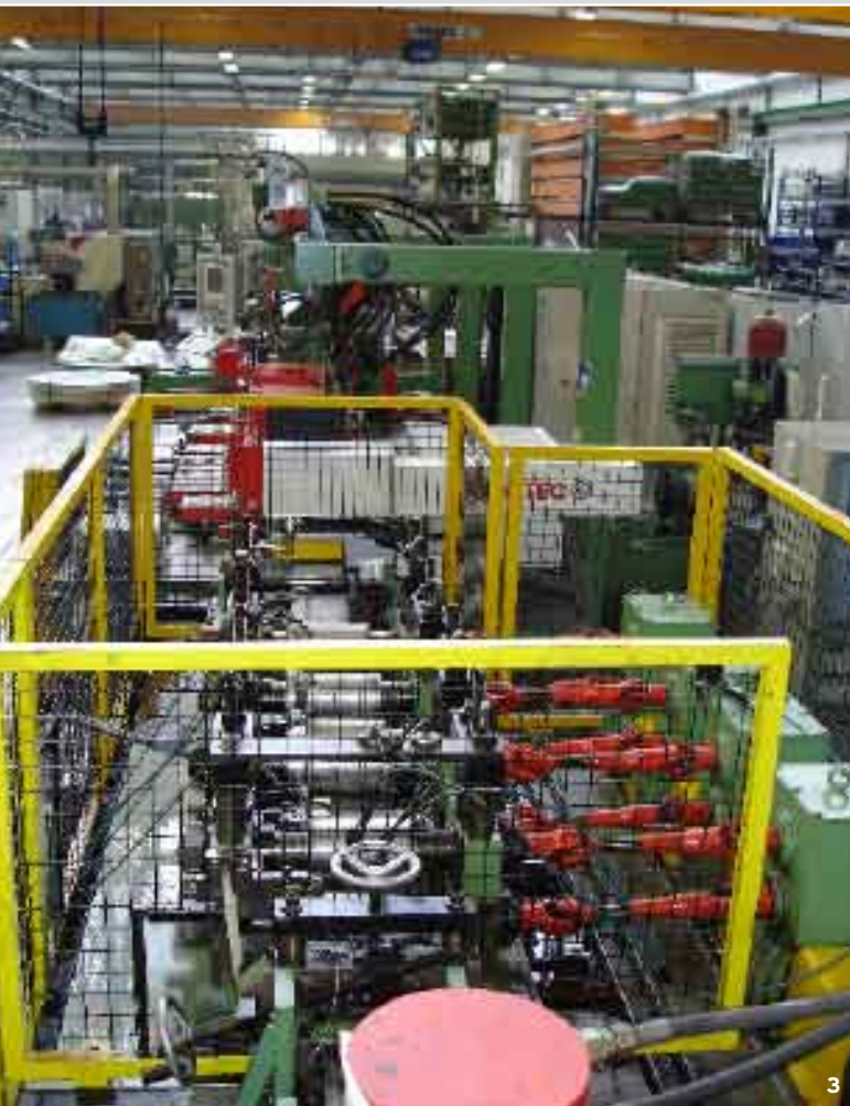
3_ Die Gesamtanlage: Vorne ist die Profilieranlage, dahinter der Stanztisch mit der Flex Control-Steuerung
